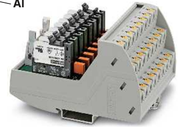
Módulo de salidas con 8 relés miniatura, 1 contacto conmutado y fusible por circuito de salida
